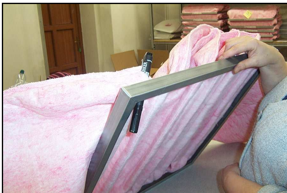
obr. 2 - - netěsnost mezi obvodovým lemem kapes a vnitřním U-profilem rámečku
