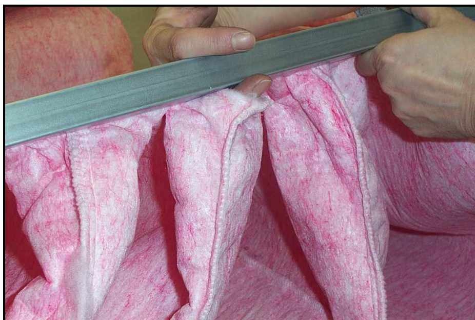
obr. 1 – netěsnost mezi obvodovým lemem kapes a vnitřním U-profilem rámečku
